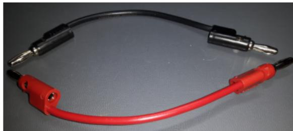
Figure 6.3 – Câbles de liaison avec fiches bananes 4 mm.
