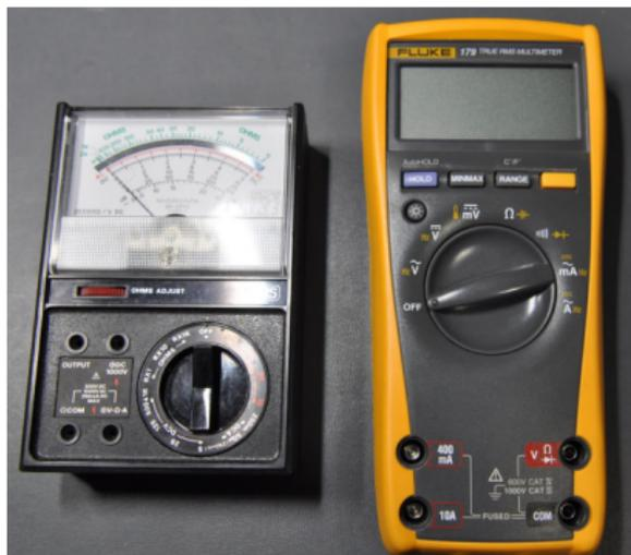
Figure 26.1 – Différents multimètres (analogue et numérique).
