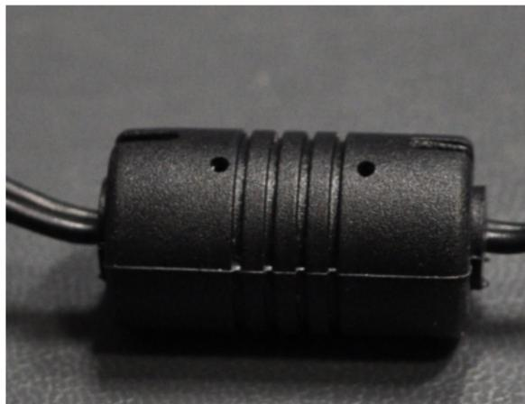
Figure 12.4 – Ferrite autour d'un fil.
