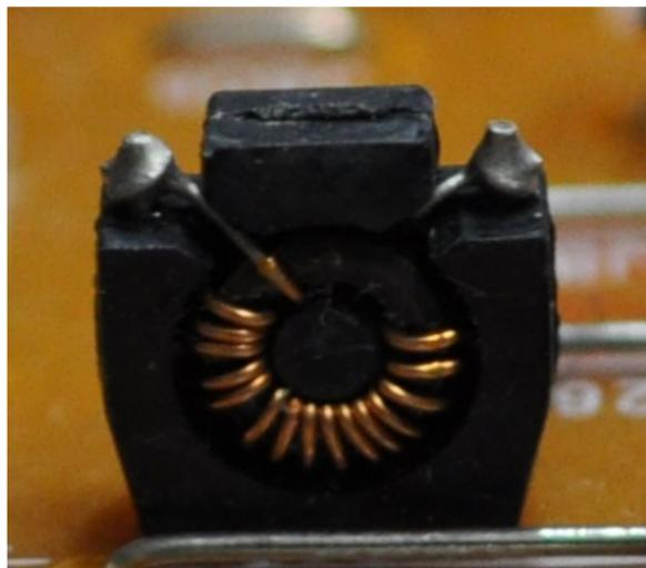
Figure 12.3 – Bobine toroïdal.
