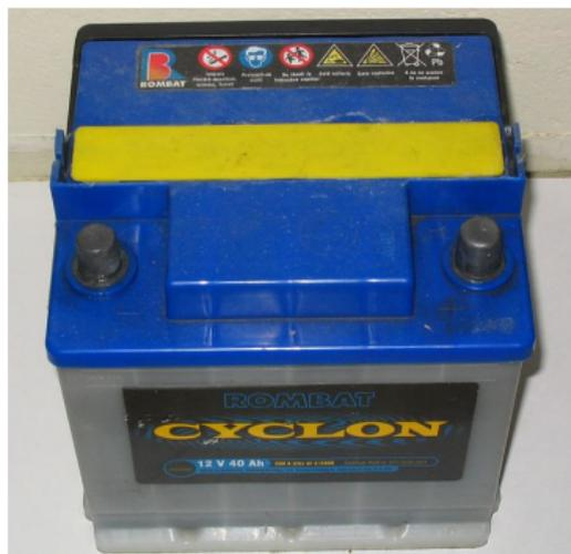
Figure 7.3 – Batterie automobile au plomb de 12V.
