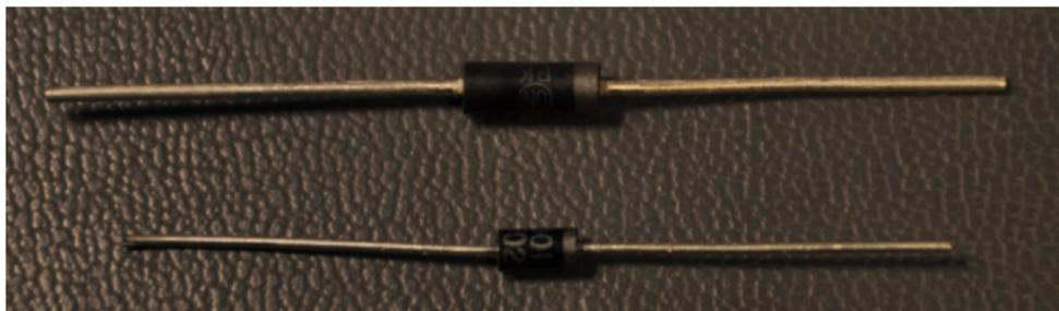
Figure 17.1 – Diodes à usage général
