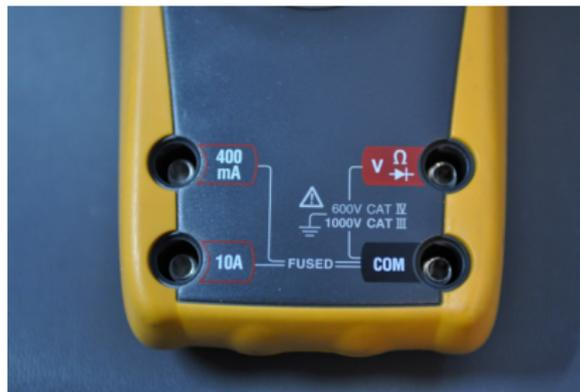
Figure 26.4 – Bornes d'un multimètre.
