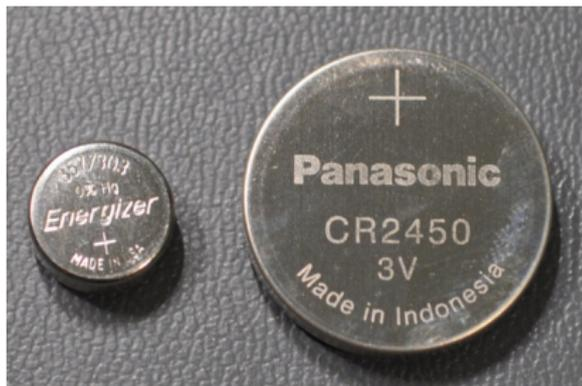
Figure 7.2 – Différents formats de piles boutons lithium.
