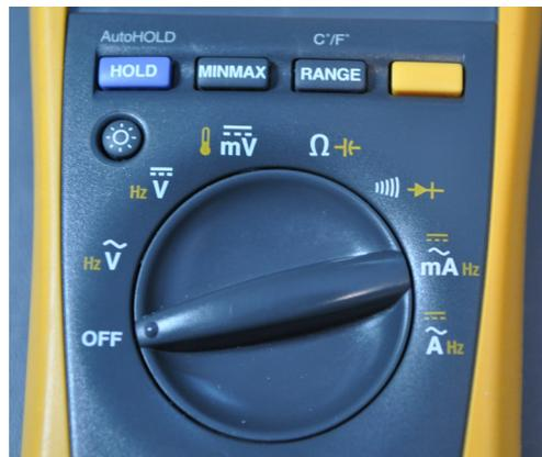
Figure 26.2 – Sélecteur de fonctions d'un multimètre.
