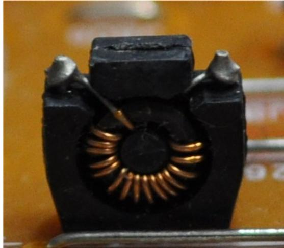
Figure 12.3 – Bobine toroïdal.
