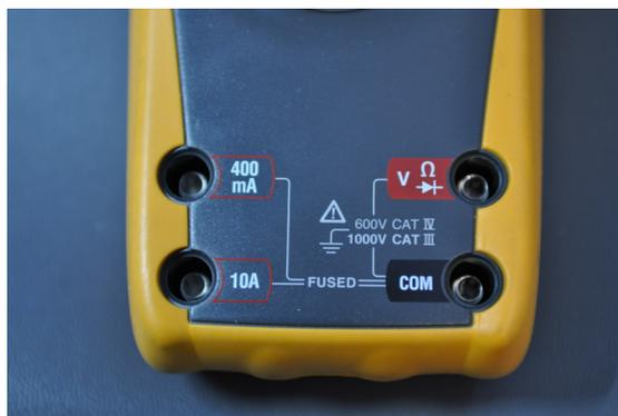
Figure 26.4 – Bornes d'un multimètre.
