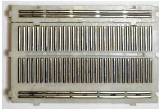
Figure 6.6 – Contacts électriques internes d'une platine d'expérimentation
