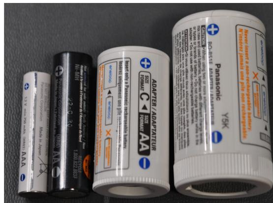
Figure 7.4 – Piles Ni-MH (AAA et AA) avec adaptateurs (C et D).
