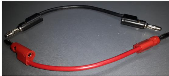
Figure 6.4 – Câbles de liaison avec fiches bananes 4 mm.
