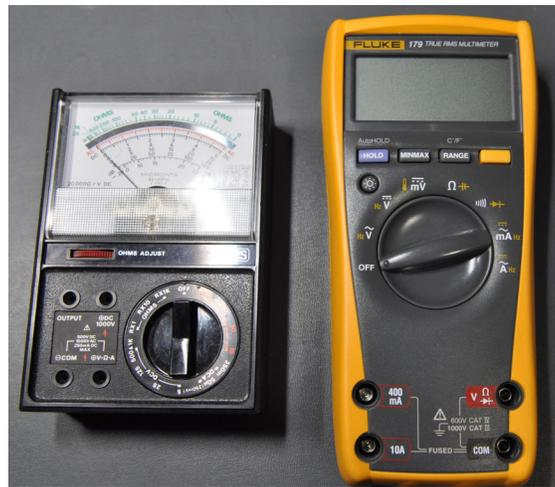
Figure 26.1 – Différents multimètres (analogique et numérique).
