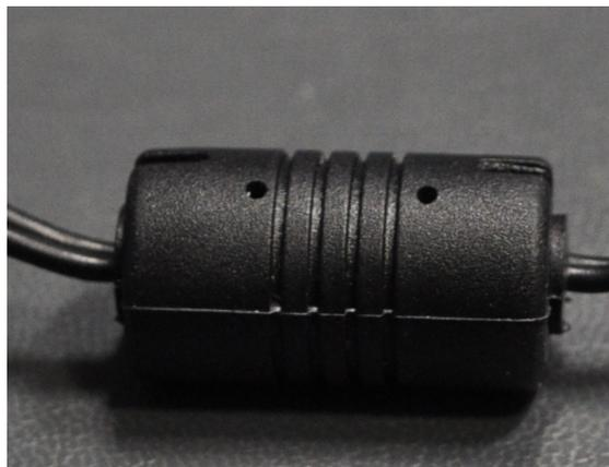
Figure 12.4 – Ferrite autour d'un fil.
